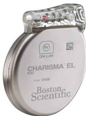
Рисунок 8 - ИКД CHARISMA™ EL ICD с мультисенсорной платформой Boston Scientific
