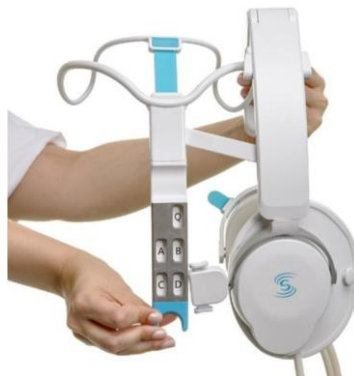
Рисунок 2 – Узел датчиков и инструмент для регулировки их положения [97]
